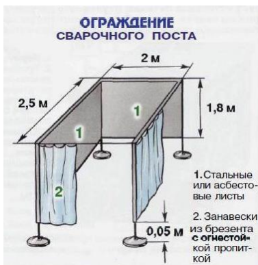
РИС 1. Ограждение сварочного поста
